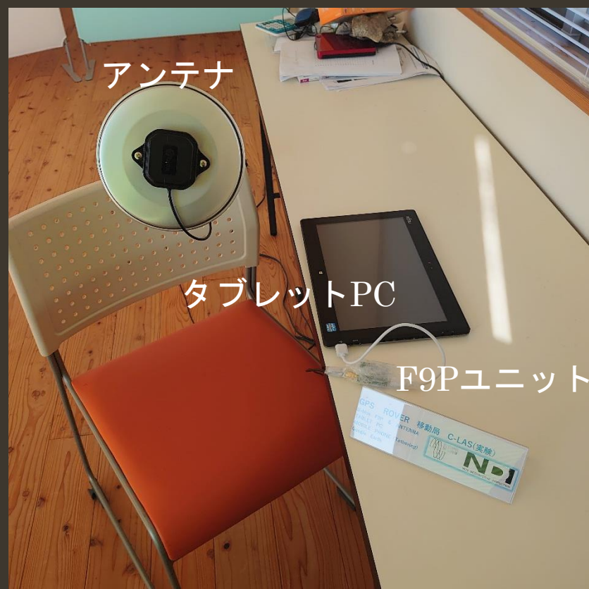
アンテナ（グランドプレーン：アル ミ鍋の蓋を自作代用）タブレット PCの横にF9Pユニット
